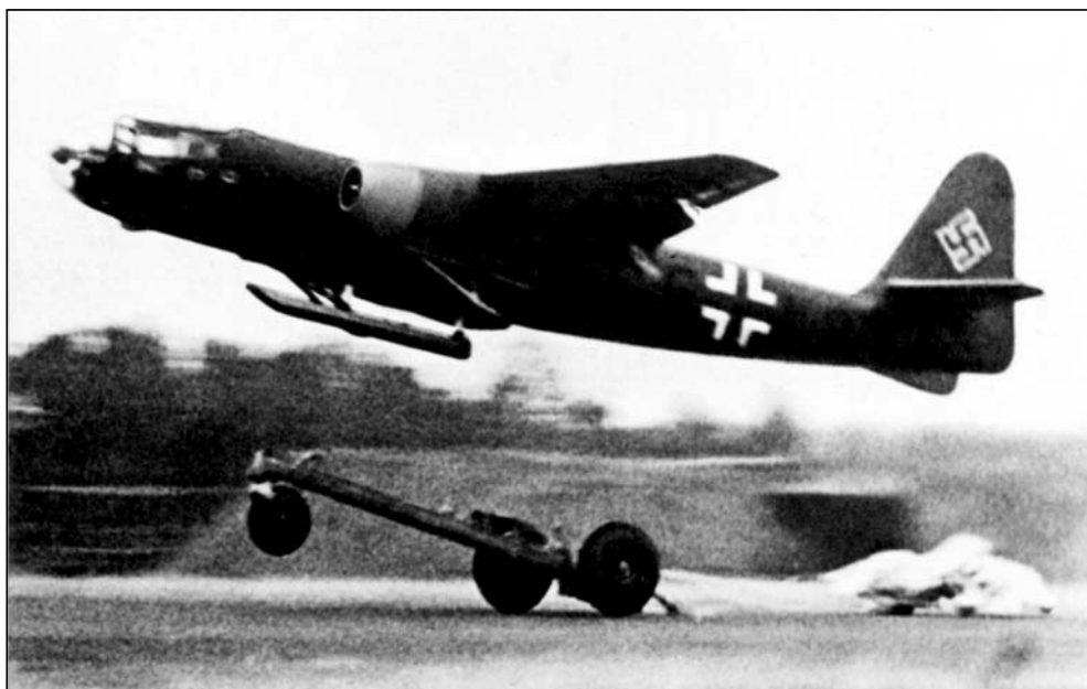
Prototyp Arado Ar 234 V5 startuje z pomocą specjalnego wózka startowego. Uwagę zwraca podwozie płożowe do lądowania.
